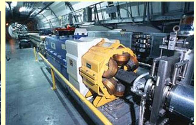
Vedení svazku magnetickými čočkami
